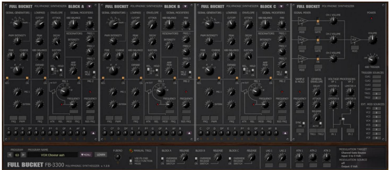
Figure 81 – FB-3300 : chœur « aah » (10.2), résonateurs réglés sur les formants de la voyelle dans les trois blocs.
