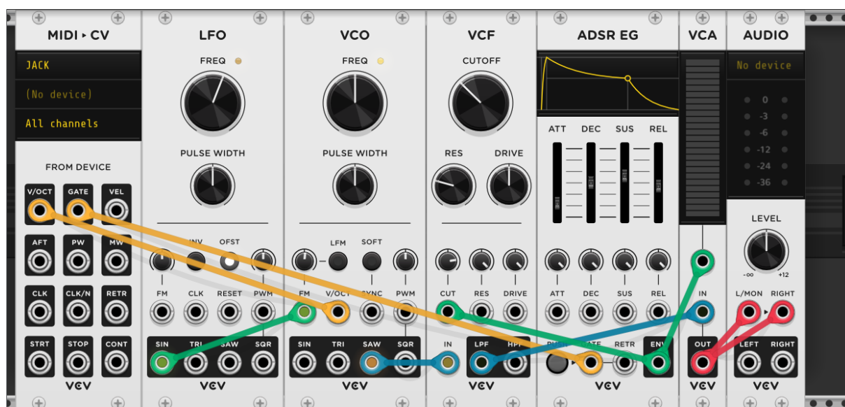
Figure 55 – VCV Rack : une voix soustractive complète (modules Core et Fundamental).
