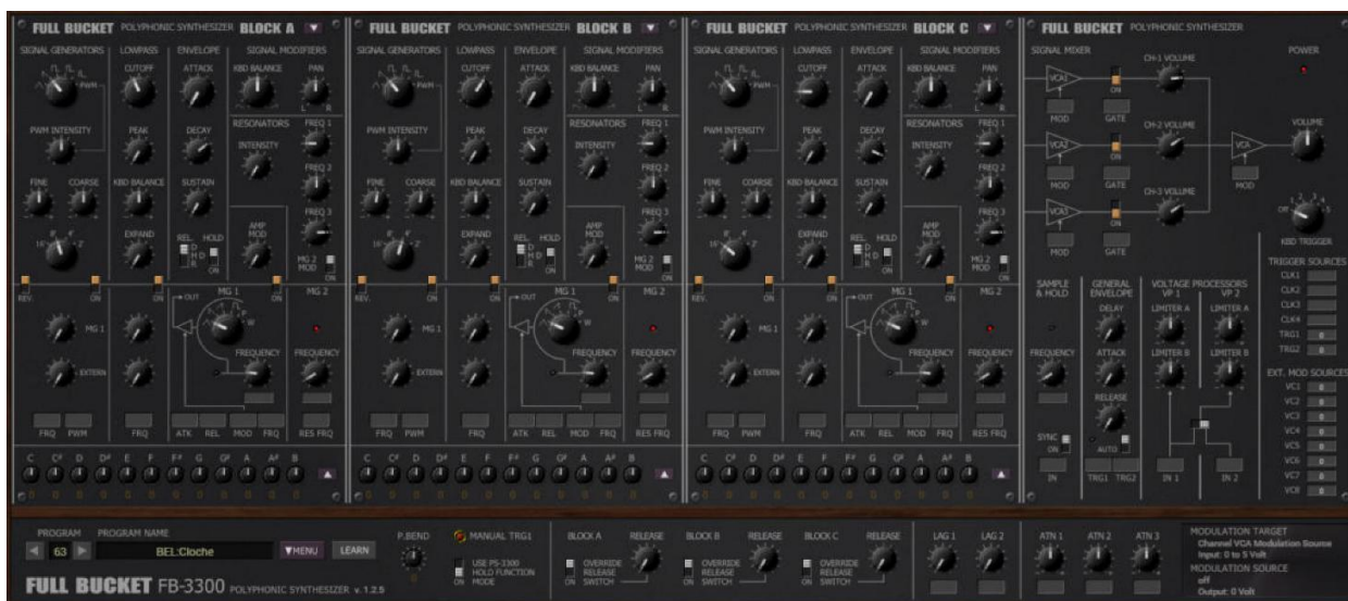
Figure 73 – FB-3300 : cloche (8.3), un partiel par bloc (8', 4' transposé, 16'), décroissances de plus en plus courtes vers l'aigu.
