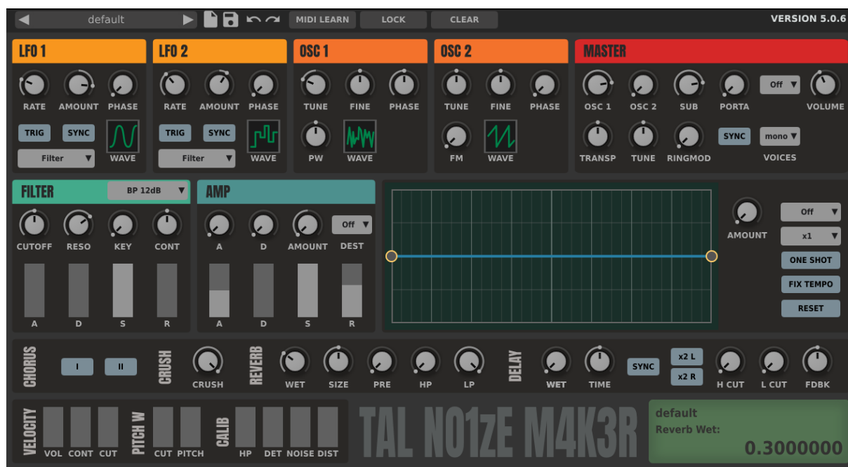
Figure 87 – TAL-NoiseMaker : le vent (12.1), bruit dans un passe-bande modulé par deux LFO.
